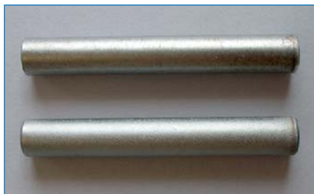
Stahl-Substrate mit Hartchrombeschichtung (Schichtdicke 25 bis 30 µm)
