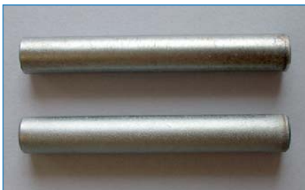
Stahl-Substrate mit Hartchrombeschichtung (Schichtdicke 25 bis 30 µm)
