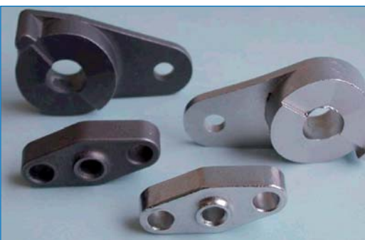
In ionischen Flüssigkeiten elektropolierte Bauteile
