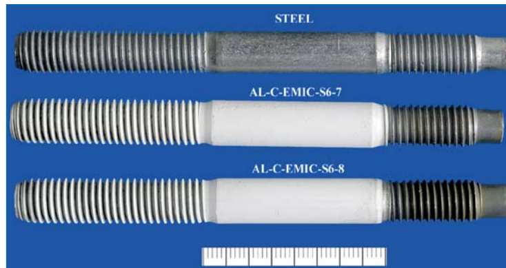
Al beschichtete Stahlsubstrate
