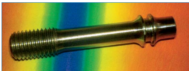
Nickellegierung (70 Prozent Ni), elektropoliert in Ethaline 200 (ein Teil Choline Chlorid: zwei Ethylen Glykol)
