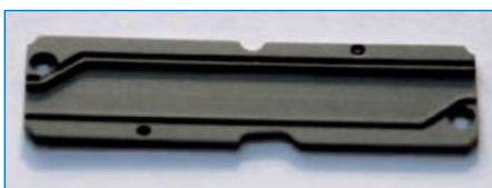
Zn-Sn-Beschichtung auf Titan
